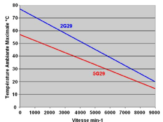
L'échauffement thermique du codeur dépend de la vitesse de rotation continue de l'axe, de l'électronique du codeur, du câble utilisé / de sa longueur, nous consulter
